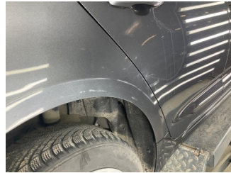
Çamurluk, sağ arka, Çamurluk, sağ arka > Ezik
