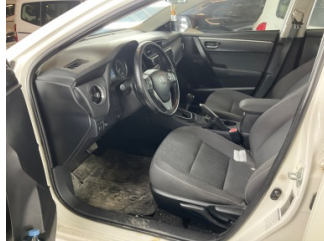
Döşemeler/Kapaklar, Döşemeler/Kapaklar > Kirlenmiş
