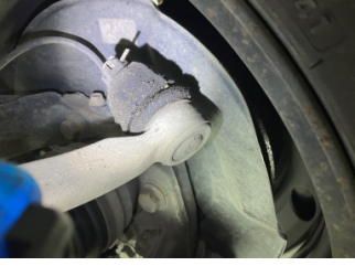
Direksiyon sistemi, Rot kolu/Rot başı, sağ > Hasarlı
