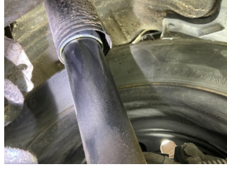
Arka aks, Amortisör, arka > Yağ Kaçağı
