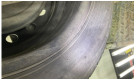
Tekerlek seti > Çatlak
