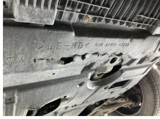
Motor, Alt muhafaza > Hasarlı
