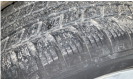
Tekerlek seti > Çatlak
