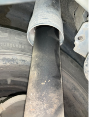
Arka aks, Amortisör, arka sol > Yağ Kaçağı
