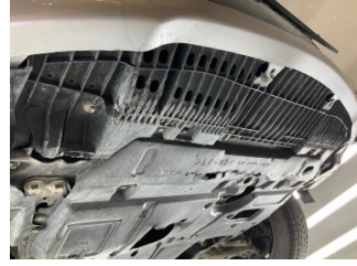
Tampon, ön, Tampon koruyucu orta > Hasarlı
