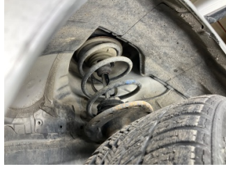
Ön aks, Amortisör körüğü, sol > Hasarlı
