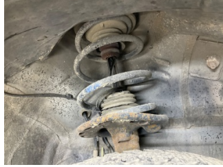
Ön aks, Amortisör körüğü, sağ > Hasarlı
