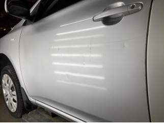
Kapı, sol ön, Kapı, sol ön > Ezik
