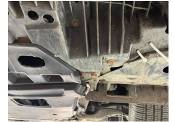
Motor, Alt muhafaza > Hasarlı
