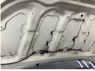
Motor kaputu, İzolasyon döşemesi > Standart Dışı Onarım
