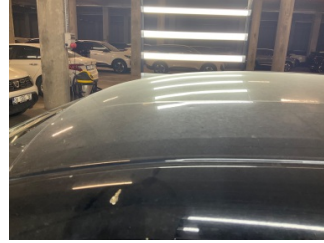
Tavan, Tavan > Dolu Hasarı
