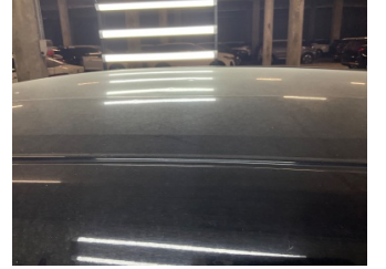
Tavan, Tavan > Dolu Hasarı
