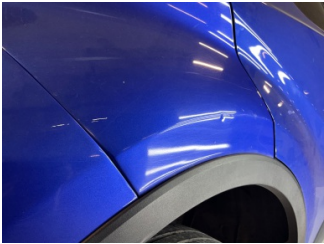
Çamurluk, sağ arka, Çamurluk, sağ arka > Ezik
