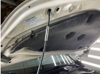
Motor kaputu, İzolasyon döşemesi > Sabitlemesi Hatalı
