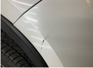
Tampon, ön, Ön tampon > Çatlak
