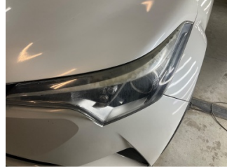
Farlar, Far camı, sol > Deforme Olmuş
