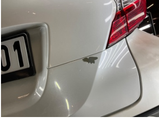
Bagaj kapağı/kapısı, Bagaj kapısı > Boyası Atmış
