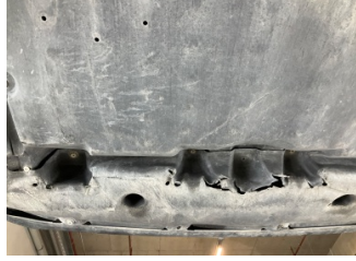
Tampon, ön, Tampon koruyucu orta > Hasarlı
