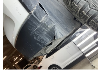
Tampon, ön, Spoiler > Kırılmış
