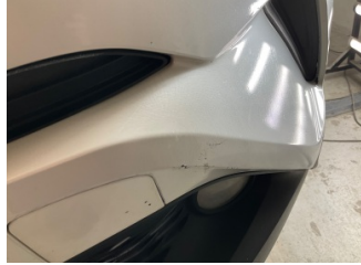
Tampon, ön, Ön tampon > Çatlak
