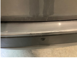
Tampon, arka, Arka tampon > Boyası Atmış
