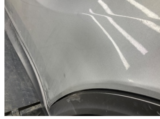
Kapı, sol arka, Kapı, sol arka > Hasarlı
