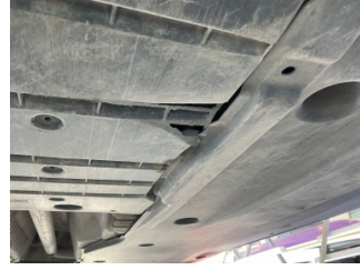
Motor, Alt muhafaza > Hasarlı
