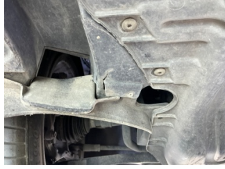
Motor, Alt muhafaza > Hasarlı
