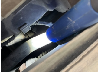
Motor, Motor > Yağ Kaçağı
