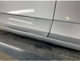
Kapı, sağ arka, Kapı, sağ arka > Ezik
