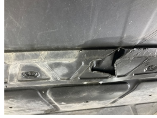
Tampon, ön, Tampon koruyucu orta > Hasarlı
