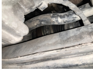
Ön aks, Aks mili, sağ > Yağ Kaçağı
