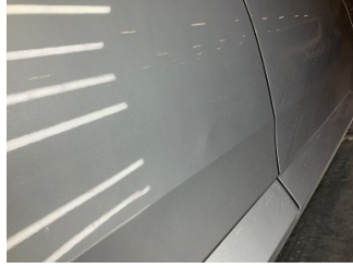
Kapı, sağ arka, Kapı, sağ arka > Ezik
