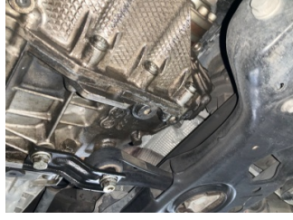
Şanzıman, Şanzıman > Yağ Kaçağı
