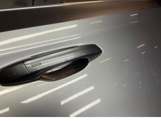
Kapı, sağ ön, Kapı kolu, dış > Çizik
