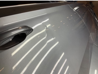
Kapı, sağ arka, Kapı, sağ arka > Ezik
