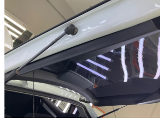
Döşemeler/Kapaklar, Bagaj kapağı, iç döşemesi > Sabitlemesi Hatalı
