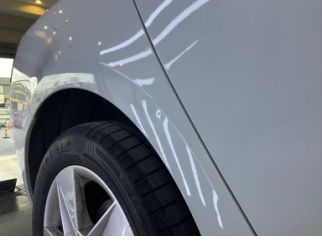
Çamurluk, sağ arka, Çamurluk, sağ arka > Ezik
