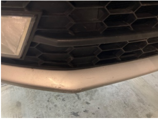
Tampon, ön, Ön tampon > Çatlak
