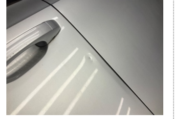
Kapı, sol ön, Kapı, sol ön > Ezik
