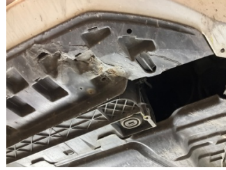
Tampon, ön, Tampon koruyucu orta > Hasarlı
