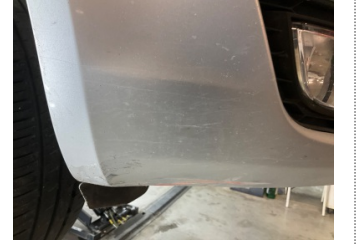
Tampon, ön, Ön tampon > Çatlak
