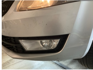
Tampon, ön, Ön tampon > Çatlak
