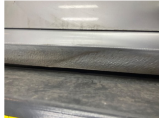
Marşbiyel, sağ, Marşbiyel, sağ > Hasarlı
