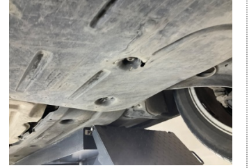
Motor, Alt muhafaza > Hasarlı
