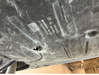
Motor, Alt muhafaza > Hasarlı
