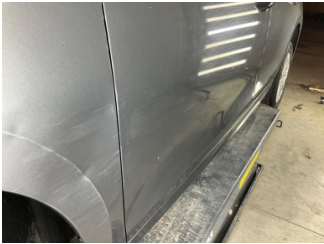
Kapı, sol ön, Kapı, sol ön > Ezık
