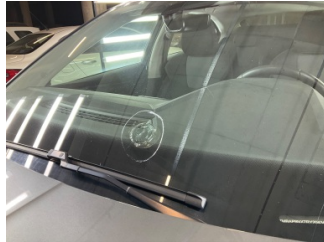
Camlar, Ön cam > Hasarlı
