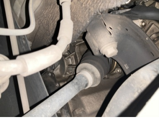
Ön aks, Aks mili, sol > Yağ Kaçağı
