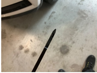
Motor, Yağ seviyesi > Eksik
