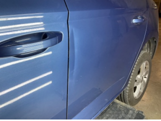
Kapı, sol arka, Kapı, sol arka > Hasarlı
