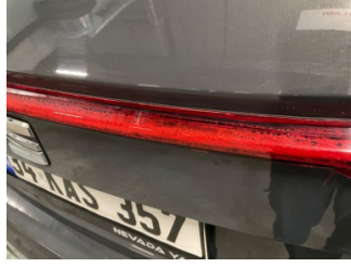
Arka lambalar, Arka lamba camı, sağ > Çatlak
