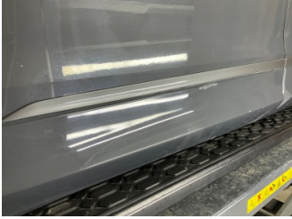
Kapı, sol ön, Kapı bandı > Çizik
