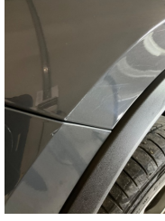
Çamurluk, sol, Çamurluk, sol > Küçük Çizik
