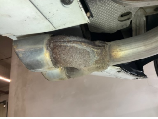
Egzoz sistemi, Arka boru > Standart Dışı Onarım
