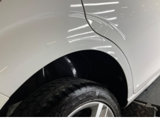
Çamurluk, sağ arka, Çamurluk, sağ arka > Ezik
