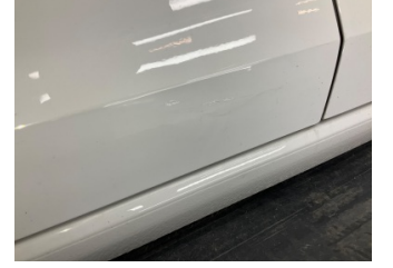
Kapı, sağ arka, Kapı, sağ arka > Rötüş
