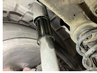
Arka aks, Amortisör, arka > Yağ Kaçağı
