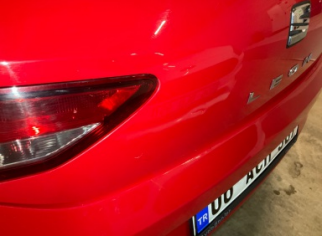
Bagaj kapağı/kapısı, Bagaj kapısı > Ezik
