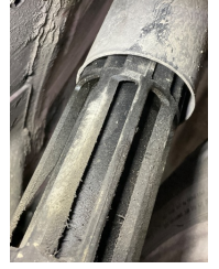
Arka aks, Amortisör, arka > Yağ Kaçağı
