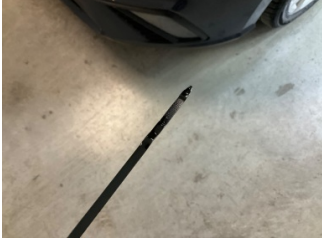
Motor, Yağ seviyesi > Eksik
