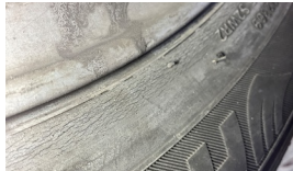
Tekerlek seti > Çatlak
