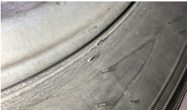
Tekerlek seti > Çatlak
