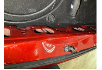
Döşemeler/Kapaklar, Yükleme eşiği kaplaması > Çizik
