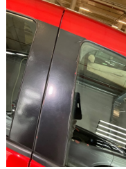
Kapı, sağ ön, Kapı bandı > Deforme Olmuş
