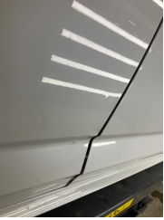
Kapı, sağ arka, Kapı, sağ arka > Ezik
