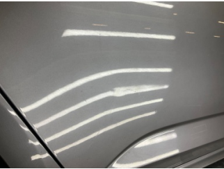
Kapı, sağ arka, Kapı, sağ arka > Ezik
