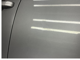
Kapı, sol arka, Kapı, sol arka > Küçük Vuruk
