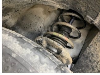
Ön aks, Amortisör körüğü, sol > Hasarlı
