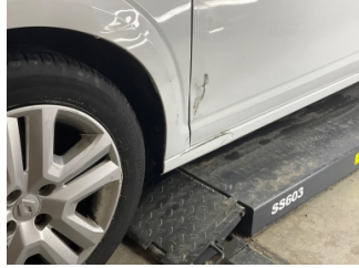
Marşbiyel, sol, Marşbiyel, sol > Hasarlı
