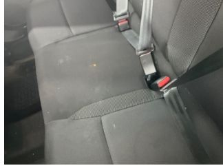
Döşemeler/Kapaklar, Döşemeler/Kapaklar > Yakıcı Madde Ile Zarar Görmüş
