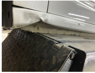
Marşbiyel, sol, Marşbiyel, sol > Hasarlı
