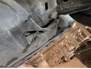
Motor, Alt muhafaza > Hasarlı
