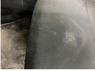
Döşemeler/Kapaklar, Döşemeler/Kapaklar > Yakıcı Madde ile Zarar Görmüş
