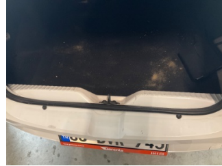
Döşemeler/Kapaklar, Yükleme eşiği kaplaması > Çizik
