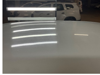
Tavan, Tavan > Dolu Hasarı
