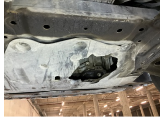
Motor, Alt muhafaza > Hasarlı
