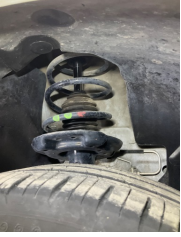
Ön aks, Amortisör körüğü, sağ > Hasarlı
