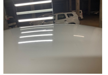
Tavan, Tavan > Dolu Hasarı
