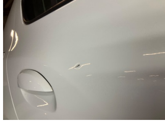
Kapı, sağ arka, Kapı, sağ arka > Ezik
