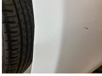
Tampon, ön, Ön tampon > Çatlak
