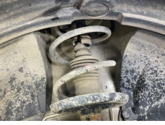
Ön aks, Amortisör körüğü, sol > Hasarlı
