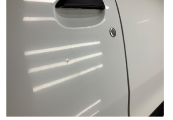
Kapı, sol ön, Kapı, sol ön > Ezik
