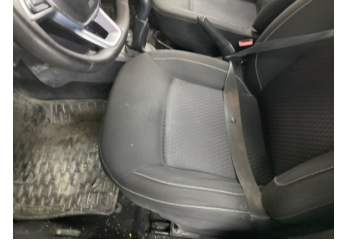
Döşemeler/Kapaklar, Döşemeler/Kapaklar > Yakıcı Madde Ile Zarar Görmüş
