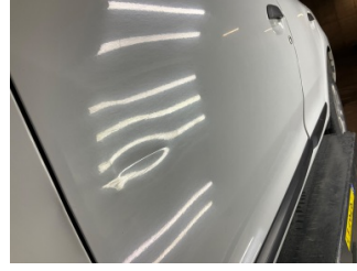
Kapı, sol ön, Kapı, sol ön > Ezik
