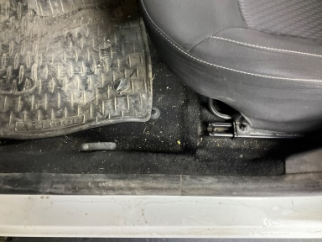
Döşemeler/Kapaklar, Döşemeler/Kapaklar > Yakıcı Madde Ile Zarar Görmüş
