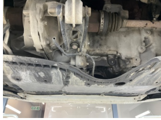
Motor, Alt muhafaza > Deforme Olmuş
