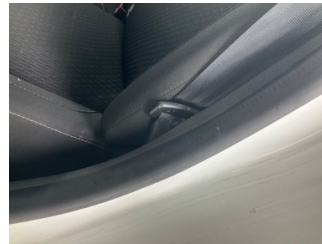
Kapı, sol arka, Kapı fitili > Deforme Olmuş
