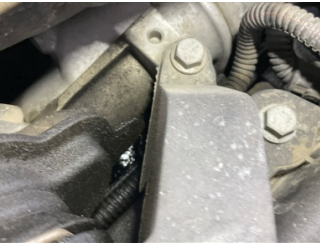
Motor, Motor > Yağ Kaçağı
