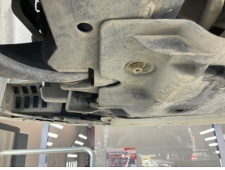
Motor, Alt muhafaza > Deforme Olmuş
