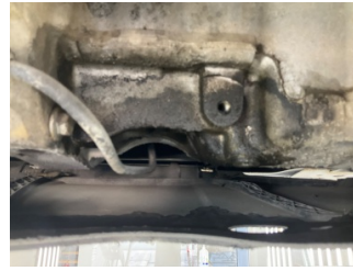
Motor, Motor > Yağ Kaçağı
