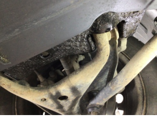
Motor, Yağ karteri > Yağ Kaçağı
