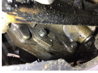
Şanzıman, Şanzıman > Yağ Kaçağı
