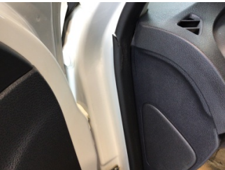
Kapı, sol ön, Kapı fitili > Hasarlı
