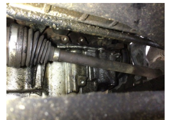
Motor, Yağ karteri > Yağ Kaçağı
