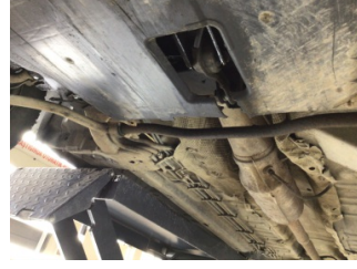
Motor, Alt muhafaza > Hasarlı
