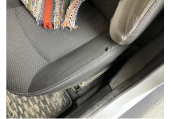
Döşemeler/Kapaklar, Döşemeler/Kapaklar > Deforme Olmuş
