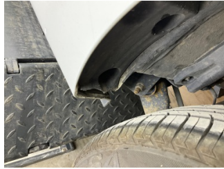
Çamurluk, sol arka, Davlumbaz > Kırılmış
