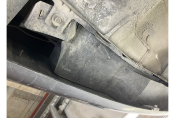
Tampon, arka, Bağlantı ayağı > Kırılmış
