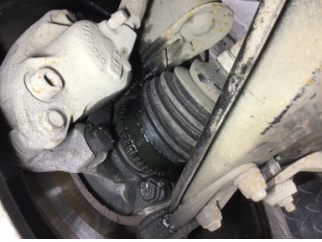
Ön aks, Aks mili, sağ > Yağ Kaçağı
