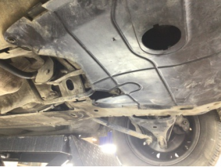
Motor, Alt muhafaza > Deforme Olmuş
