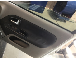
Döşemeler/Kapaklar, Kapı döşemesi, sağ ön > Deforme Olmuş
