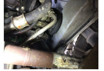
Direksiyon sistemi, Hidrolik pompası > Yağ Kaçağı
