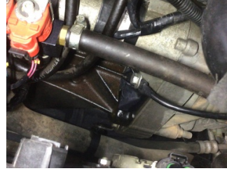
Motor, Silindir kapağı contası > Yağ Kaçağı
