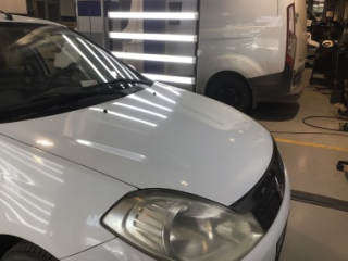
Motor kaputu, Motor kaputu > Dolu Hasarı
