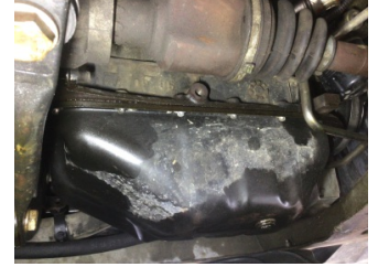
Motor, Yağ karteri > Yağ Kaçağı
