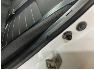
Kapı, sol arka, Kapı fitili > Hasarlı
