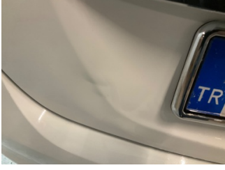
Bagaj kapağı/kapısı, Bagaj kapısı > Ezik
