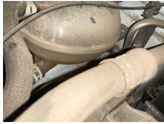
Motorsoğutması, Soğutma sıvısı > Eksik
