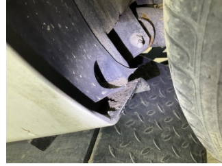
Çamurluk, sol arka, Davlumbaz > Kırılmış
