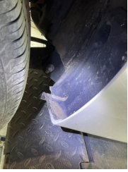
Çamurluk, sağ arka, Davlumbaz > Kırılmış
