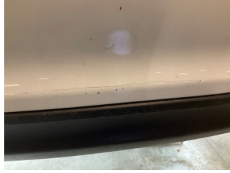
Tampon, arka, Arka tampon > Çatlak
