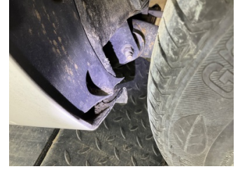
Çamurluk, sol arka, Davlumbaz > Kırılmış
