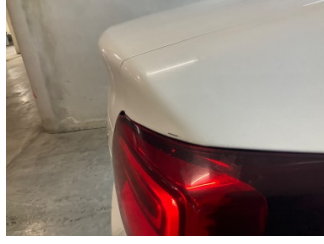
Çamurluk, sağ arka, Çamurluk, sağ arka > Ezik
