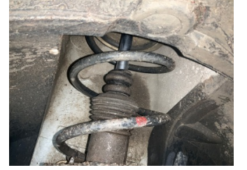
Ön aks, Amortisör körüğü, sağ > Hasarlı
