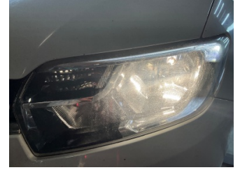
Farlar, Far camı, sol > Deforme Olmuş
