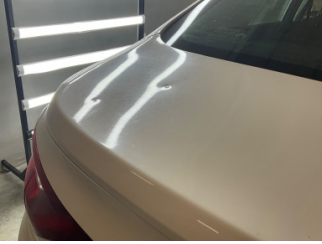
Bagaj kapağı/kapısı, Bagaj kapısı > Noktasal Ezik
