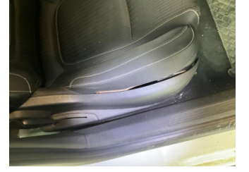
Koltuklar, ön, Koltuk çerçevesi altı, sağ ön > Hasarlı
