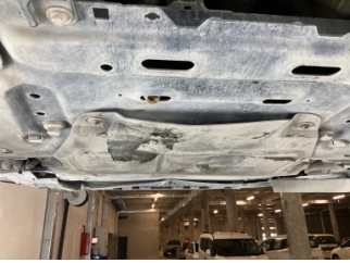
Motor, Alt muhafaza > Hasarlı
