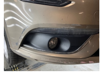
Sis lambaları, Sis farı camı, sağ > Hasarlı
