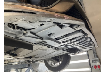
Tampon, ön, Tampon koruyucu orta > Hasarlı
