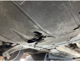
Motor, Alt muhafaza > Hasarlı
