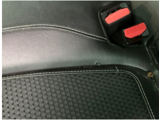
Döşemeler/Kapaklar, Döşemeler/Kapaklar > Yakıcı Madde Ile Zarar Görmüş
