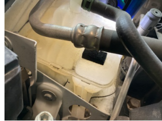
Motorsoğutması, Soğutma sıvısı > Eksik
